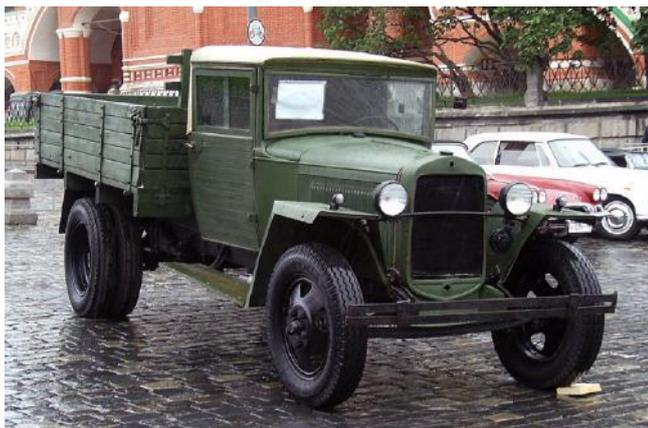
Из названия понятно, что автомобиль обладает грузоподъемностью в 1.5 тонны. Производилась машина с 1932 по 1950 годы на Горьковском автозаводе. Максимальная скорость в реальных условиях редко переваливала за 40 км/ч, причем это было на ровном покрытии, а не на снегу и льду, о которых пойдет речь дальше.
